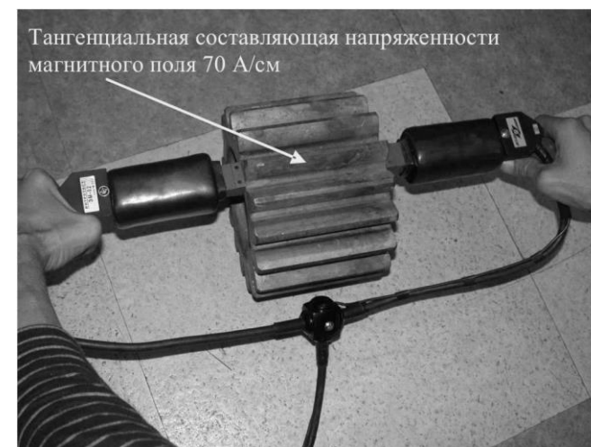
Рис.2 Намагничивание отдельных зубьев шестерни электромагнитом с разъединенными сердечниками
