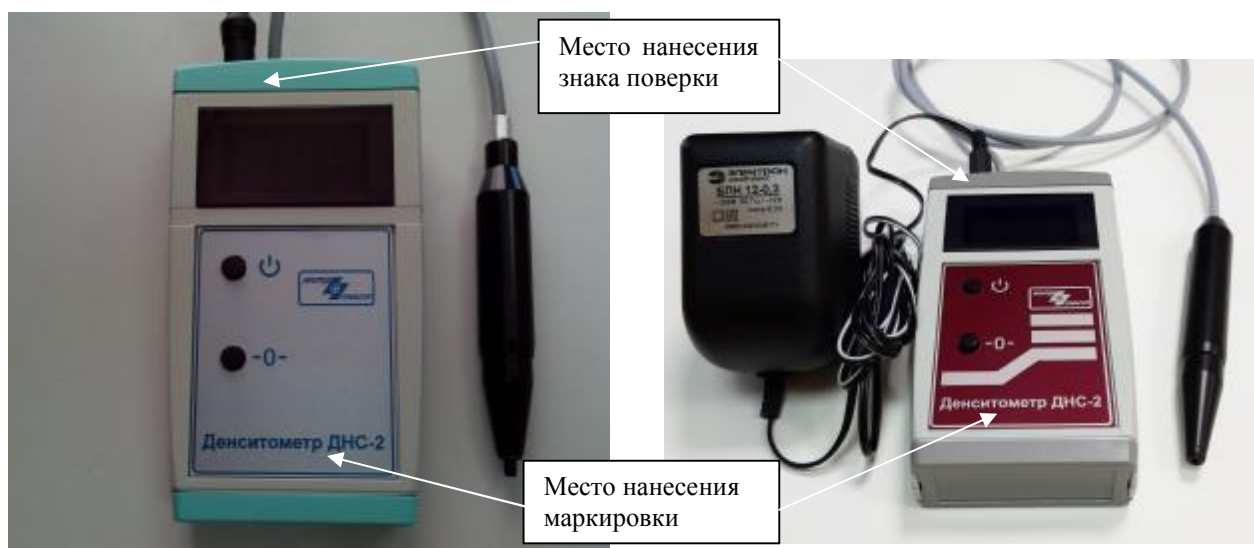
Рисунок 1 -Общий вид денситометров с обозначением места нанесения маркировки и знака поверки
