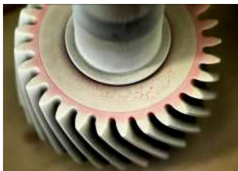
Индикация дефектов с помощью контрастной капиллярной системы
