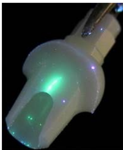
Индикация дефектов с помощью флуоресцентной капиллярной системы
