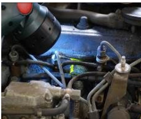
Регистрация утечки в двигателе с помощью флуоресцентного концентрата Н 800
